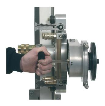
Tres tipos de protectores están disponibles: El Standard con un deflector pivotante que permite un control optimo del corte, el total que cubre completamente el corte y el protector de ras de muro.
