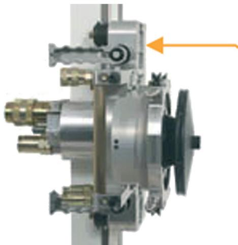
La posición de la guía permite que los rodillos estén unos encima de los otros en el mismo plano del corte, para reducir torsiones.
