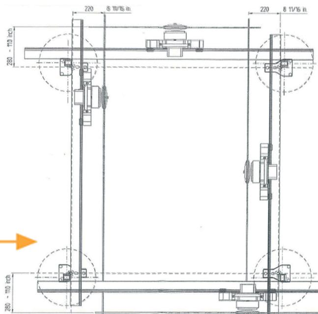
El giro del soporte de la pata junto al diseño de la guía permite un rápido cambio de corte.
