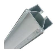
Estos raíles en aluminio son extremadamente ligeros con un peso de solamente 6,7 Kg por metro y pueden por tanto ser facilmente manipulados por un solo operario, lo que disminuye el cansancio aumentando así la seguridad durante las operaciones de colocación. La rigidez y la estabilidad del sistema son más que suficientes para absorber las cargas y esfuerzos del corte, aun con discos de gran diámetro.
